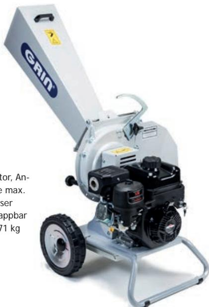
B&S XR Professional 4-Takt-Motor, Antrieb mit Keilriemen, Aststärke max. 5 cm, Schneidsystem mit 2 Messer und 6 Hämmer, Trichter aufklappbar für Reinigung oder Transport, 71 kg
