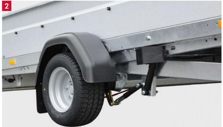
Beim Auf- und Abfahren mit einem Fahrzeug, ändert sich die Schwerpunktlage. Dadurch hebt oder senkt sich die Kippbrücke.
