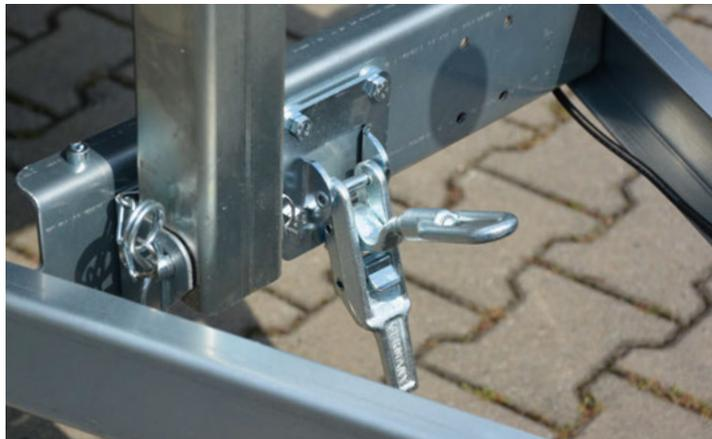
Befestigung der Kippbrücke über Sicherungsspannverschluss.
