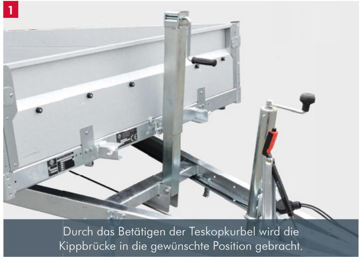
Durch das Betätigen der Teleskopkurbel wird die Kippbrücke in die gewünschte Position gebracht.
